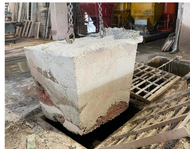
Par ailleurs, les surplus de béton produits en usine sont systématiquement reconditionnés sous forme de blocs non vibrés et non armés, puis acheminés vers une entreprise voisine de concassage, située dans la même zone industrielle.
